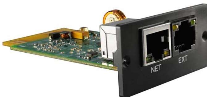
Рис.1. Модуль удаленного мониторинга «SNMP iDA-ST200R» для ИБП
